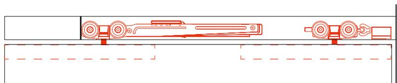
Das Pure finish integriert die Aufhängung im Türblatt. Diese Fertigung wird meistens benutzt bei raumhohen Lösungen wo die Schiene in der Decke integriert ist.
