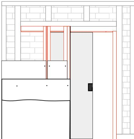
Im Renovierungsfall bei einer bereits existierenden Wand ist es mit unserem X5 Wandsystem möglich mit einer Tasche die Schiebetür zwischen der existierenden Wand und der neu errichteten verschwinden zu lassen.
