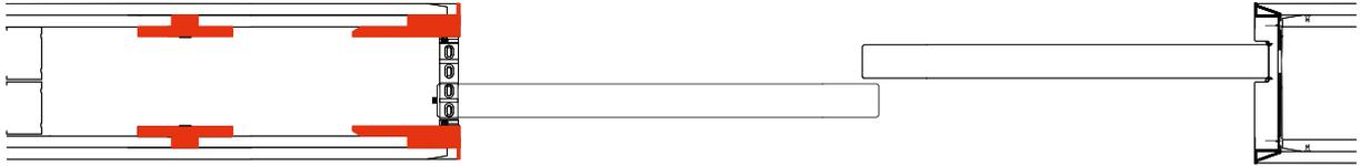
Bei Einsatz des teleskopischen Systems verschwinden beide Türblätter in der gleichen Wand. Somit kann ein größerer Durchgang realisiert werden.
