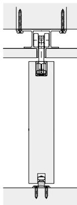
Verwenden Sie unsere langen Aufhängungsbolzen für eine deckenhohe Lösung ohne sichtbare Schiene.
