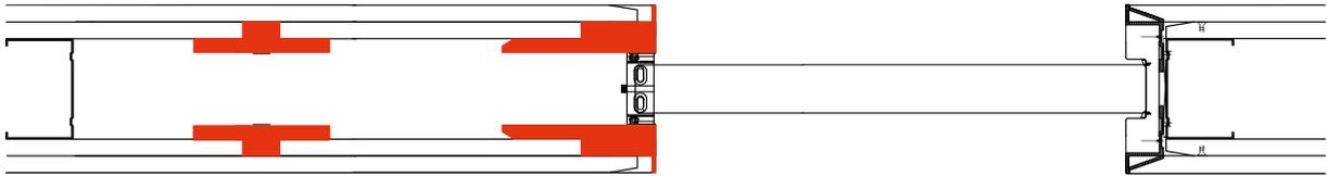
Unsere Schiebetür verschwindet in einer Standard Wandstärke wodurch es möglich wird beide Wandseiten optimal zu nutzen. Mit unseren Standardelementen können die gewünschten Höhen (bis zu 3515 mm) und Breiten (1230 mm) realisiert werden.
